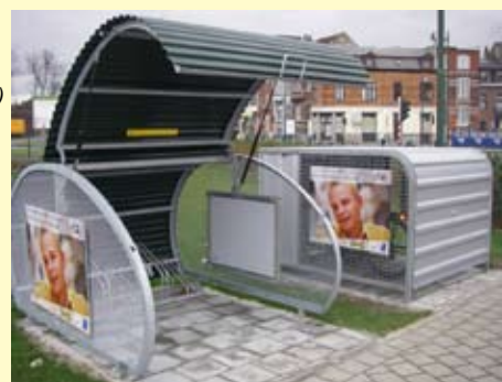
Tambour qui permet le stationnement de 4 à 5 vélos sur un espace privatif ou public (Bruxelles)
